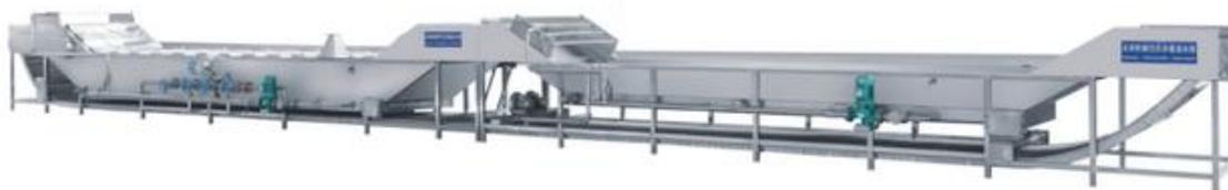
*Figura 7.11 - Equipo pasteurizador de sólidos.*
