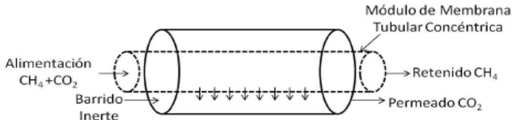
Figura 6.21- Membrana con barrido inerte
