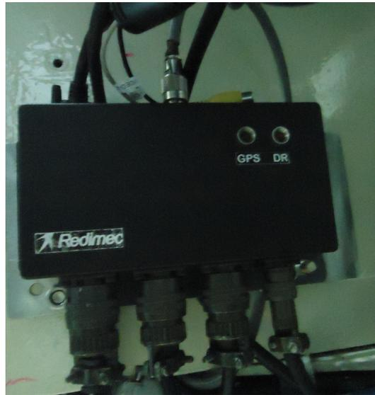
Figura 6.6: Sistema instalado en el submarino, abajo las entradas del GPS, la corredera, y el girocompás y arriba la salida al plotter Garmin.
