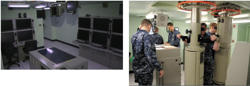
Figura A.5: Simulador de radar y control (izq), y simulador de snorkel (der)
