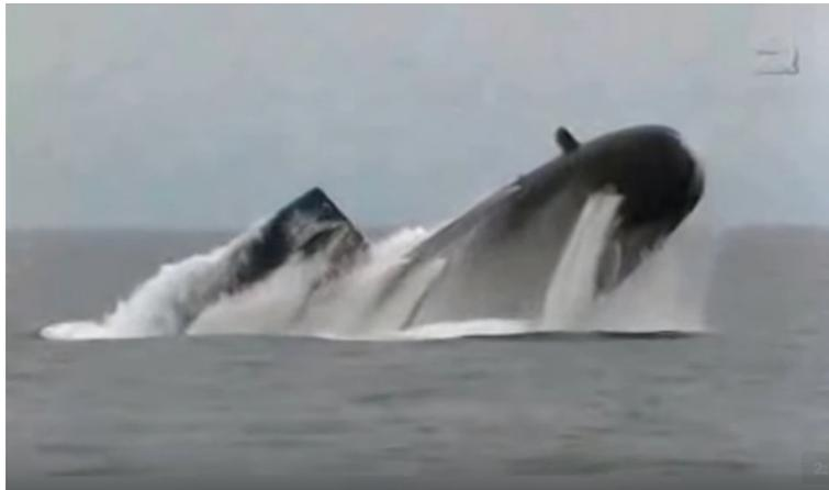
Figura 4.2: Imagen de un submarino ruso realizando una emersión de emergencia.
