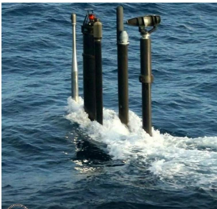
Figura 4.3: Imagen de snorkel (punta roja) y antenas de un submarino navegando a profundidad de periscopio.
