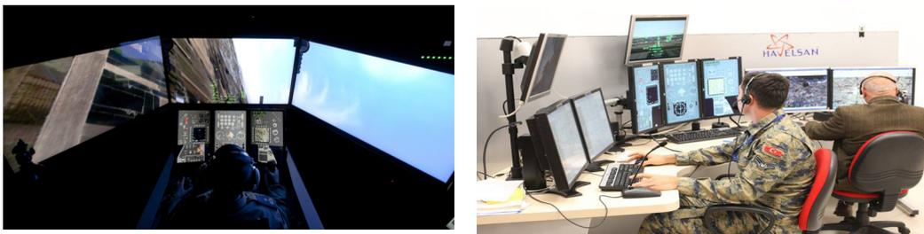
Figura A.1: Interior del simulador de vuelo de un jet F-16 (izq). Simulador de un vehículo no tripulado (der).
