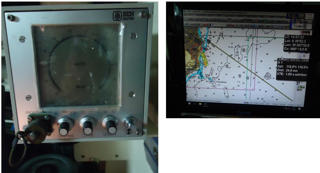
Figura 6.4: Corredera LMN-5 (izq). Imagen del software EUREKA que muestra la posición en base a información Plotter Garmin GPSMAP 5012 (der).
