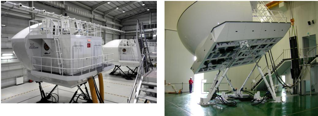
Figura A.2: Simuladores de helicóptero S-70. (izq). Ángulo máximo que puede adoptar el simulador del S-70 y tamaño real respecto de una persona (der).
