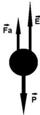
Figura 7.16: Diagrama de cuerpo aislado del submarino.
