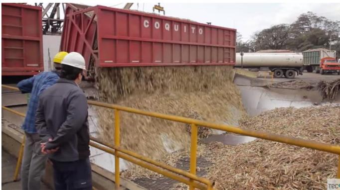
En la figura 1 se observa como la caña de azúcar es descargada en la cinta transportadora para luego hacer ingreso a la planta.
