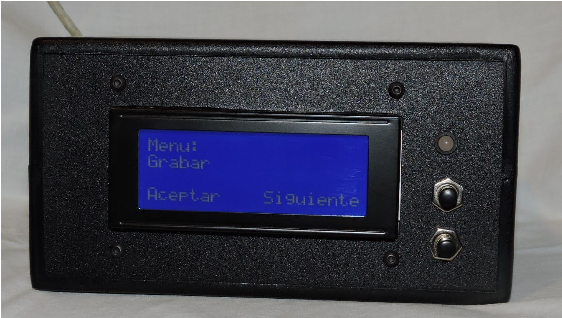
Figura 58 - Frente del dispositivo con el display de 20x4, los dos pulsadores y el LED bicolor
