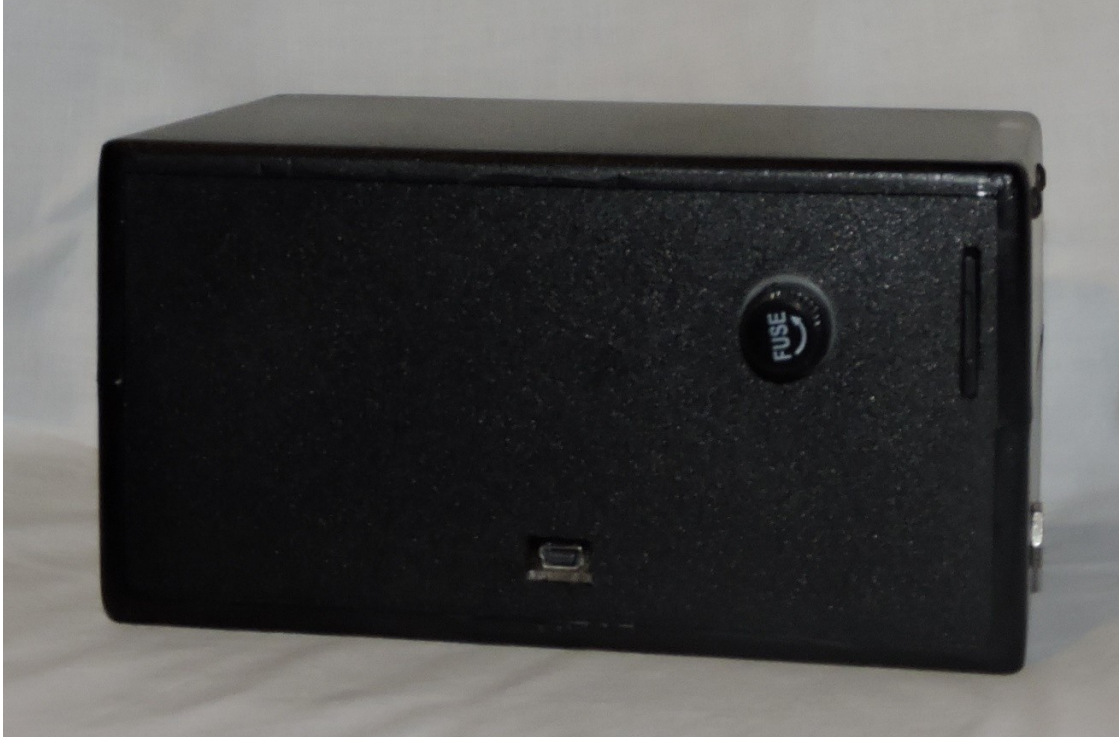
Figura 60 - Ranura para la tarjeta SD, porta-fusible y puerto mini-USB
