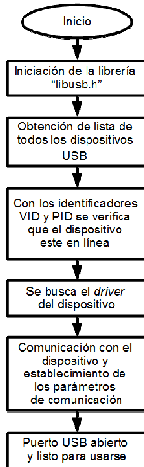
Figura 4. 13. Diagrama de flujo de la configuración USB. Si alguno de estos pasos no se cumple, se aborta la comunicación y deberá intentarse nuevamente
