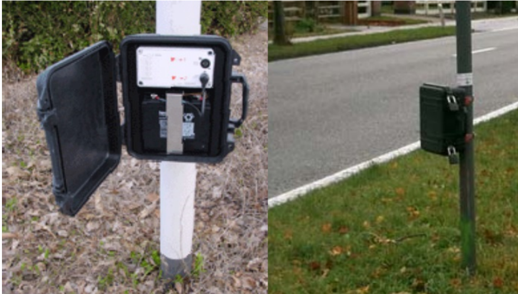
Ilustración 12: radar Trans-Q en apostado para el análisis.
