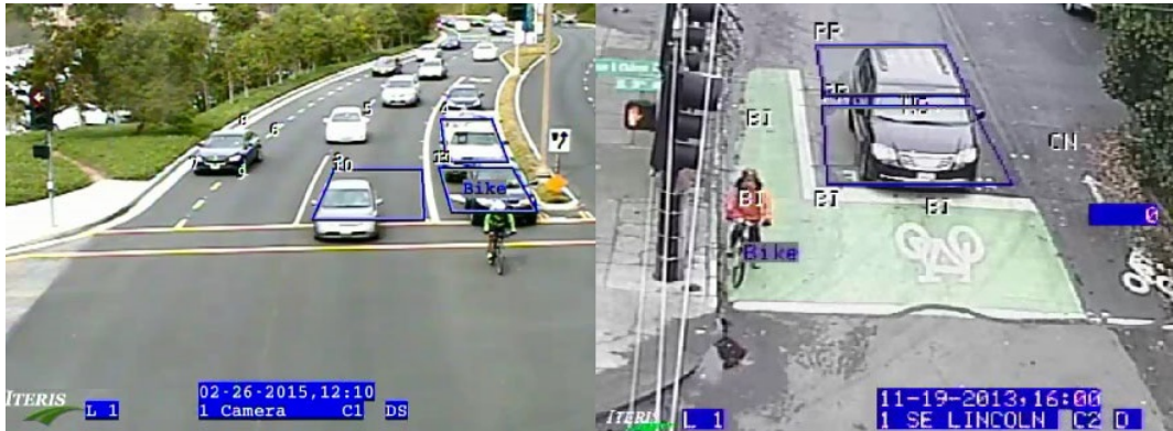
Ilustración 15: ejemplos de sistemas de video-detección vehicular.
