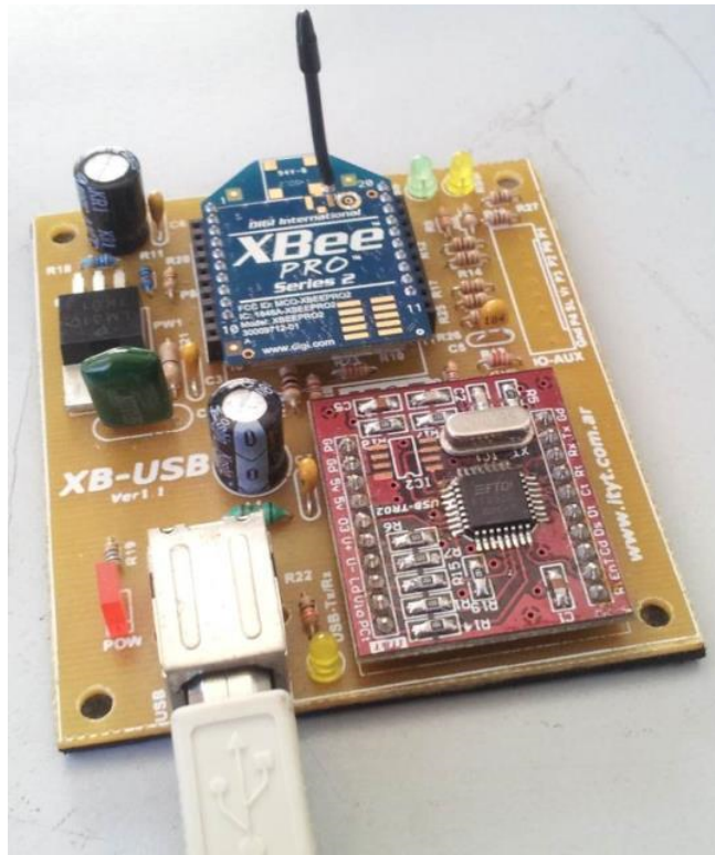
Ilustración 21: interface USB de programación para XBee's.
