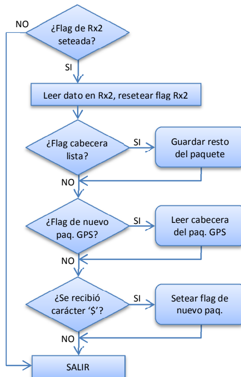
Ilustración 33: diagrama de flujo de la rutina de atención a interrupciones de Rx2.
