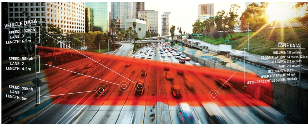
Ilustración 14: imagen demostrativa del método de trabajo del SmartSensor HD.
