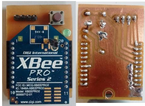
Ilustración 38: placa adaptadora para el XBee del dispositivo M2.
