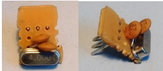
Ilustración 44: circuito del oscilador externo del dispositivo M1.
