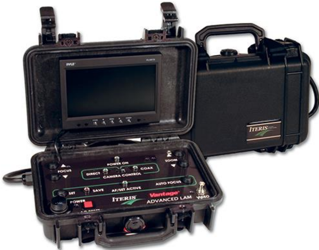
Ilustración 17: el LAM permite realizar ajustes de campo sobre la configuración de la cámara.
