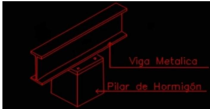
*Figura 9.31 – Ejemplo de viga apoyada.*
