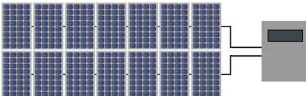
Figura 8.18 – Conexión de paneles en el inversor
