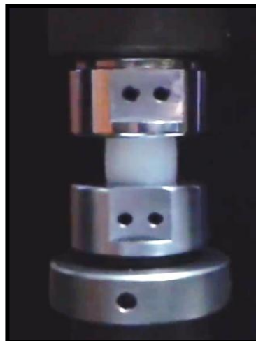
Figura 8. Configuración usada en los ensayos de compresión uniaxial.
