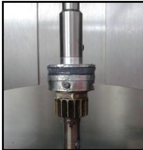
Figura 6. Configuración de platos paralelos empleada en los ensayos de reometría oscilatorios.
