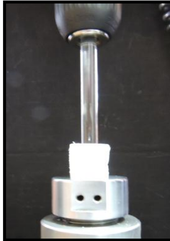
Figura 7. Configuración usada en los ensayos de macroindentación.
