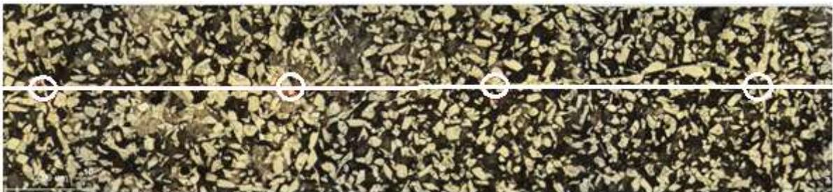
Figura 5.6. Detalle de la intercepción de bordes de grano con una línea trazada. Muestras correspondientes al acero SC.
