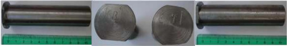
Figura 4.1. Probetas Jominy utilizadas para los ensayos de templabilidad.
