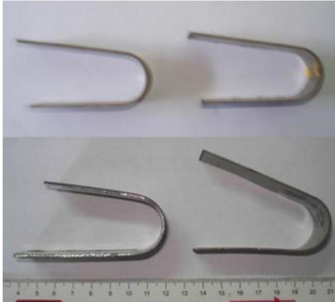
**Figura 2.8.** Probetas luego de realizado el ensayo de *springback*.
