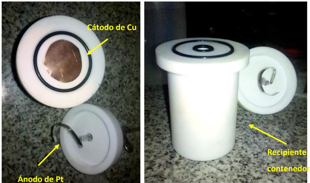
Figura 13. Recipiente utilizado para contener la solución. A la izquierda se observan las tapas del recipiente contenedor. A la derecha, recipiente contenedor.
