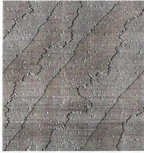
**Figura 3.** Superficie de silicio analizada con STM. Pueden observarse átomos y vacancias. Las líneas corresponden a escalones que poseen igual altura que el diámetro de los átomos de Si.
