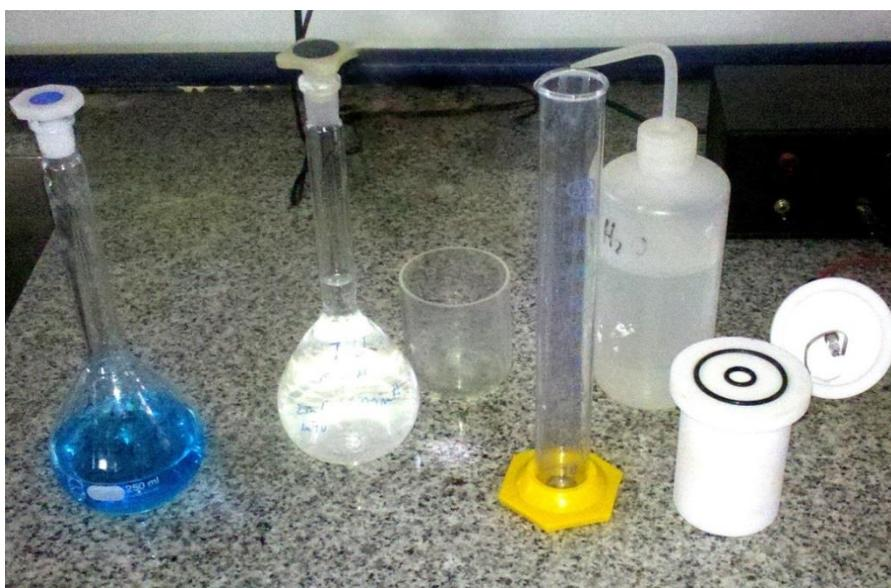
**Figura 11.** Soluciones utilizadas para la realización de los experimentos. De izquierda a derecha se observa: solución de sulfato de cobre ( $\text{CuSO}_4$ ) 0,3 M y 1,2 M  $\text{H}_2\text{SO}_4$ ; solución de Tiourea 1,4 M; agua destilada.
