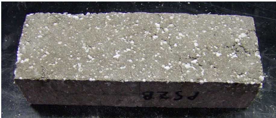
Fig. 4.8.3 – Fisura desplazada (PS2)
