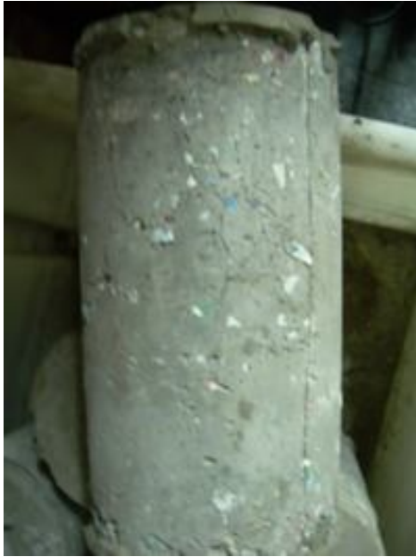
Fig. 4.13.3 – Hormigón con PP
