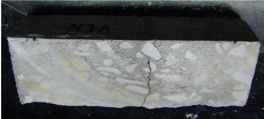
Fig. 4.8.2 – HN - Propagación de fisura
