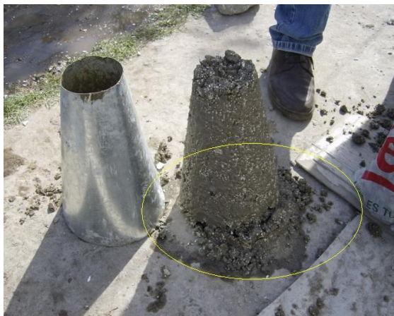
Figura 4.1 – Presencia de agua libre
