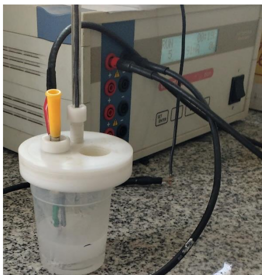
Figura 10. Celda utilizada para la realización del anodizado.
