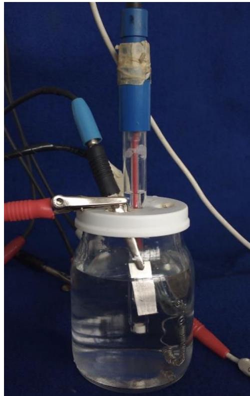
Figura 14. Celda utilizada para ensayos electroquímicos.
