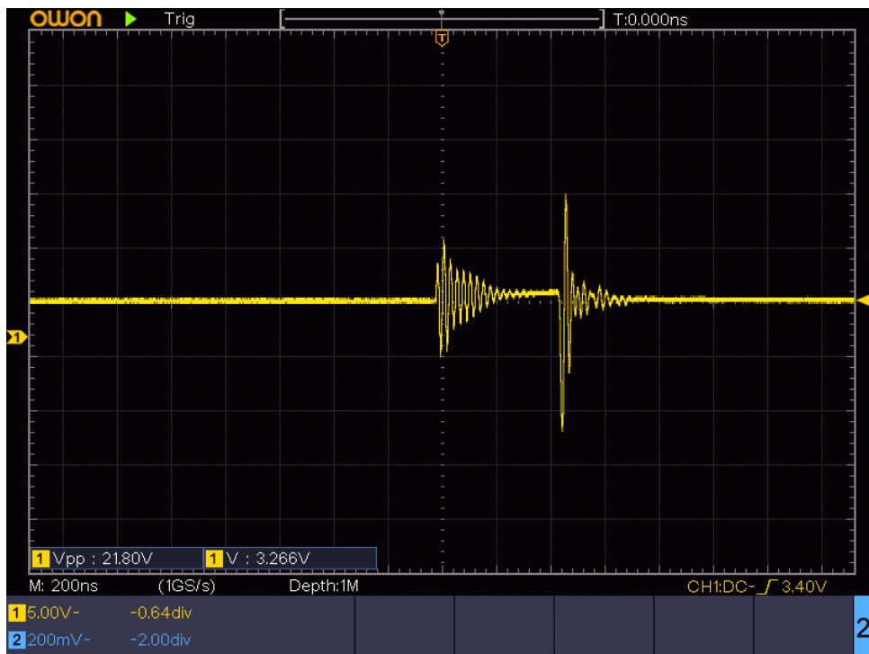
Figura 63: salida de la fuente de 3,3V en KUH V1.
