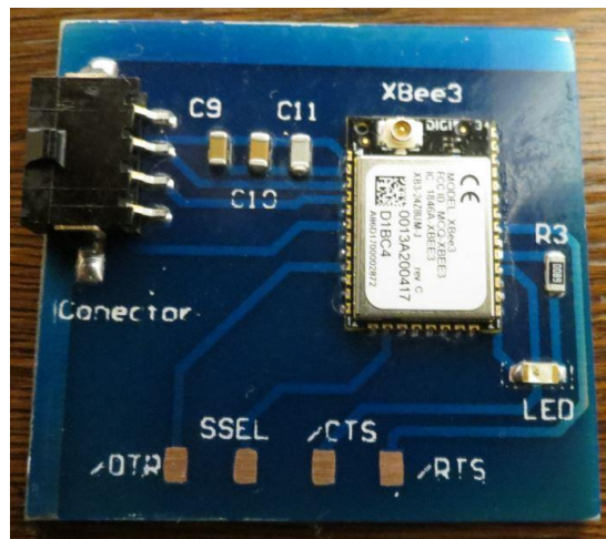
Figura 33: placa del módulo de comunicación XBee.
