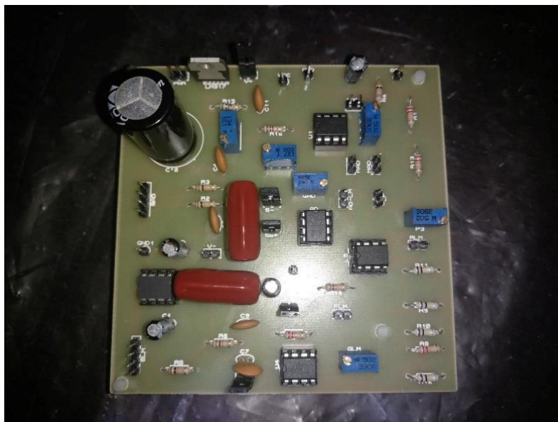
Figura 26: prototipo para análisis de AD620 vs LM358.
