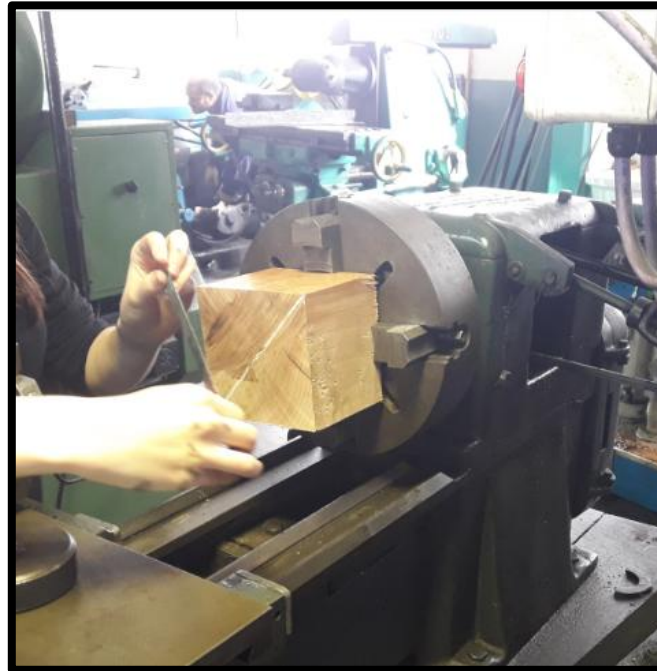
Figura 5.6, Preparación del taco de madera para ser mecanizado.
