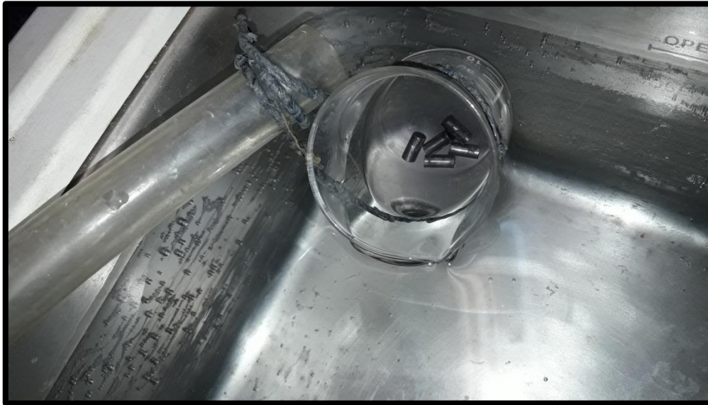
Figura 5.12, Lavado realizado con ultrasonido con agua destilada.
