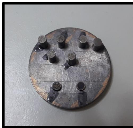
Figura 5.11, Probetas posicionadas para ser observadas mediante microscopio electrónico.
