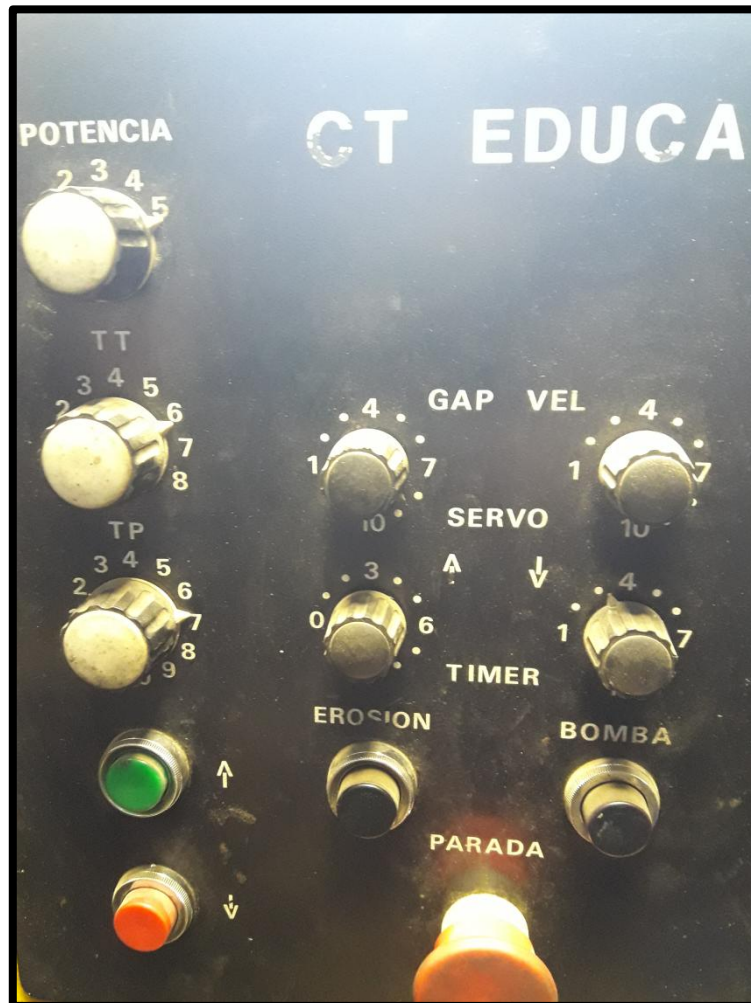
Figura 5.9, Tablero de la electroerosionadora EDUCA 10.
