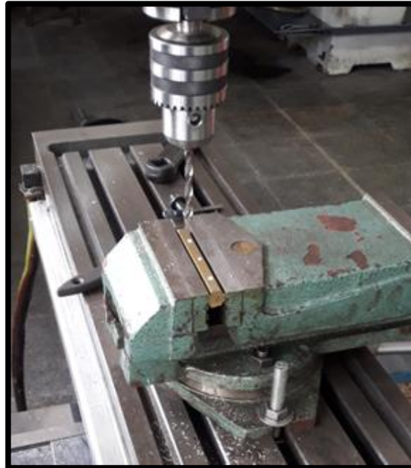
Figura 5.2, Imagen tomada luego de haber hecho los asientos para las probetas.
