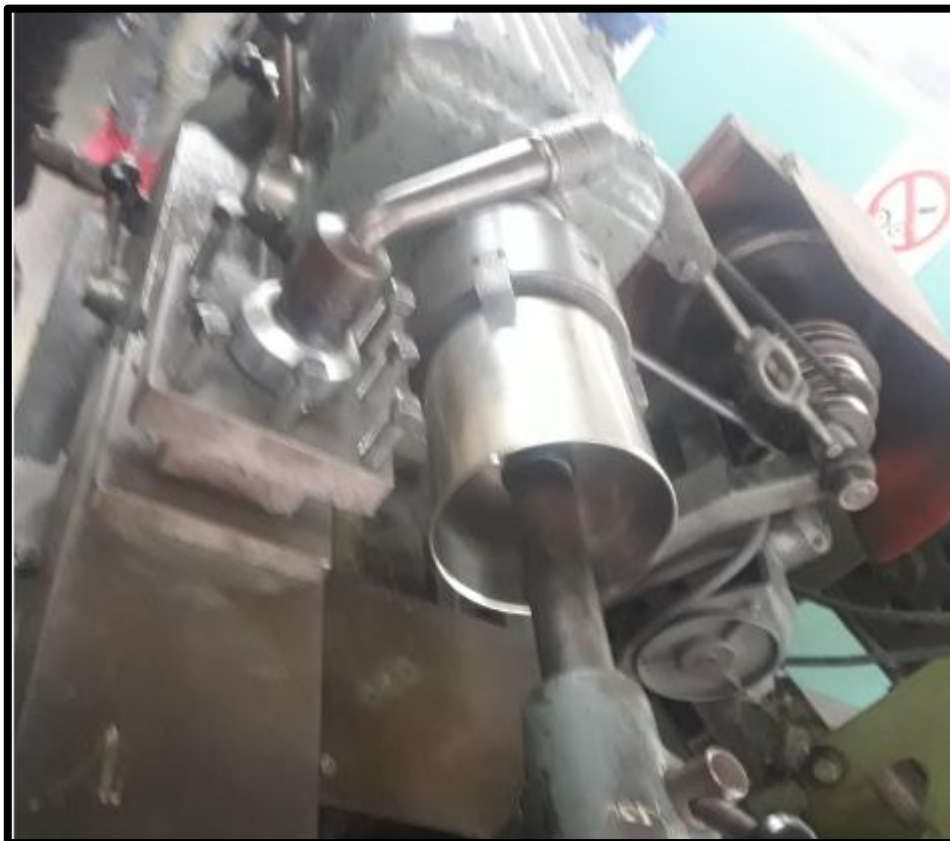
Figura 5.5, Disposición del recipiente para realizar el primer corte.
