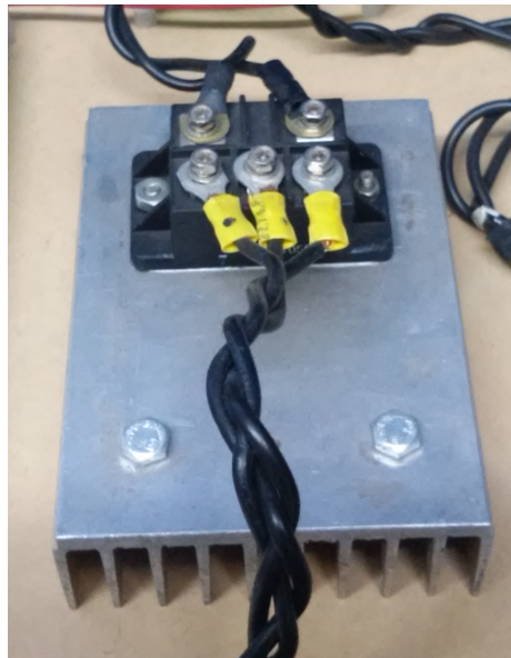
Figura 2.7: Montaje rectificador trifásico.
