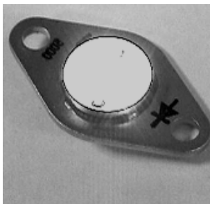
Figura II.4. Diagrama esquemático de la LED montada sobre un sustrato de BeO. El diámetro del área irradiada es igual al diámetro de la muestra. Como el dispositivo es delgado se alcanza un perfecto contacto con la muestra, y ésta recibe todos los fotones irradiados por la LED.
