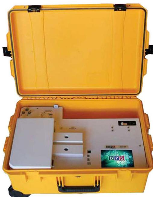
Figura 6-9: Cromatógrafo de gases portátil Companion 2<sup>81</sup>.
