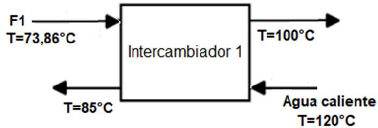
Figura 5-10: Intercambiador para calentar la corriente F1.
