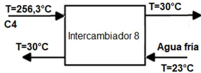
Figura 5-16: Intercambiador para enfriar la corriente C4.
