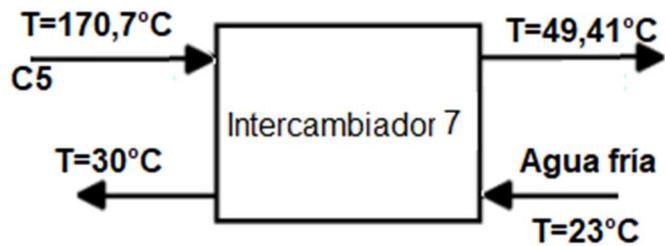
Figura 5-15: Intercambiador para enfriar la corriente C5.
