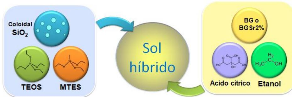
**Figura 6** – Composición del sol híbrido utilizado como recubrimiento.
