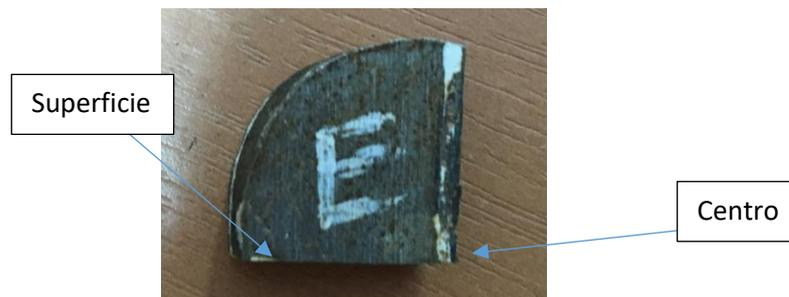
Figura 7.1 Esquema representativo del centro y superficie para las muestras de Keel Block
