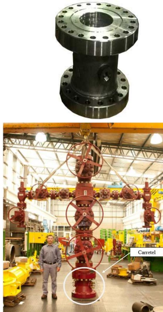
Figura 2.1. Carretel (arriba), carretel en cabezal de extracción (abajo)
