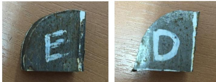
Figura 6.2: muestras E (izquierda), D (derecha) utilizadas para realizar la caracterización macroestructural de los Keel Block.
