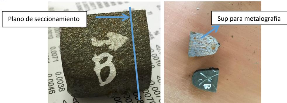
Figura 6.1: muestra B antes (izquierda) y después (derecha) del corte con la sierra refrigerada.
