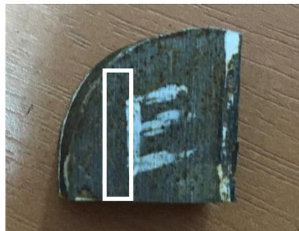
Figura 7.2: Detalle de la zona donde fueron obtenidas las micrografías para determinación de tamaño de grano austenítico en Keel Block (muestra E 0.13% de Ti).
