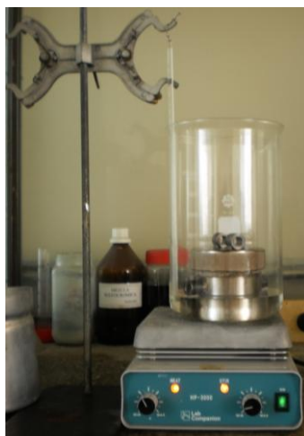
Figura 2.4 Montaje del equipo de síntesis hidrotermal.
