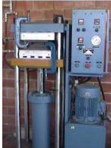
**Figura 6.** Prensa hidráulica utilizada en el procedimiento 2.
