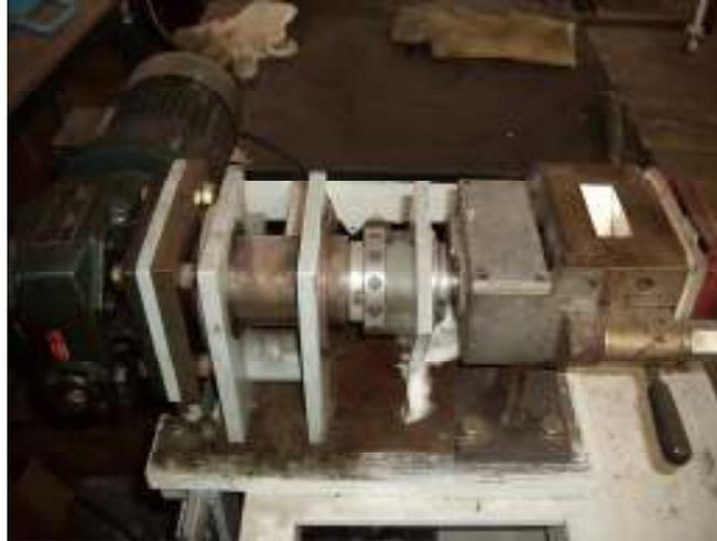
**Figura 5.** Mezclador tipo Brabender utilizado en el procedimiento 2.
