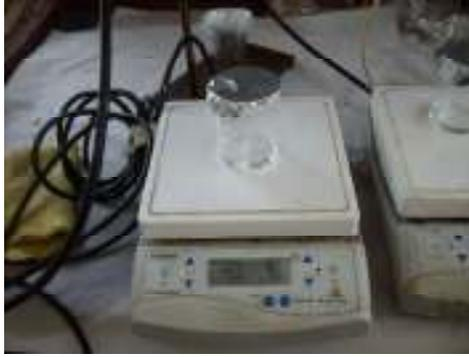
**Figura 4.** Placa calefactora utilizada en la preparación del TPS y de las mezclas PS:TPS
