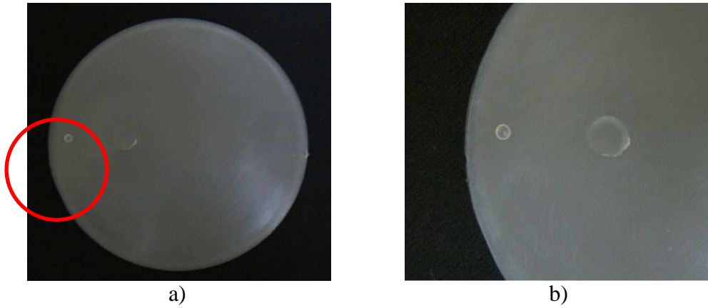
Figura 3.11. a) Aire ocluido, b) detalle de la burbuja de aire
