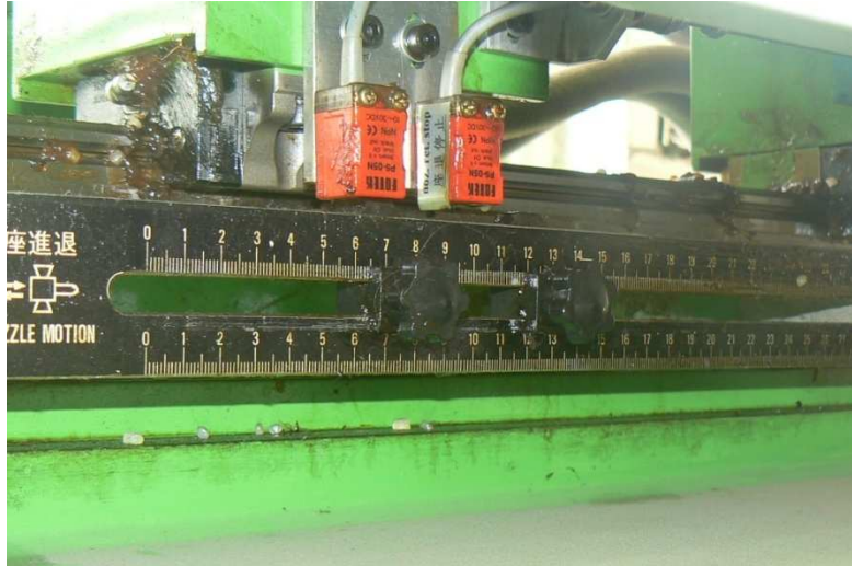
Figura 3.5. Posición final de avance del carro y posición final de retracción del carro.
