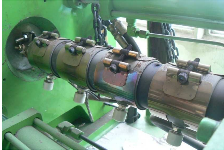
Figura 3.7. Sistema de calentamiento de la camisa.
