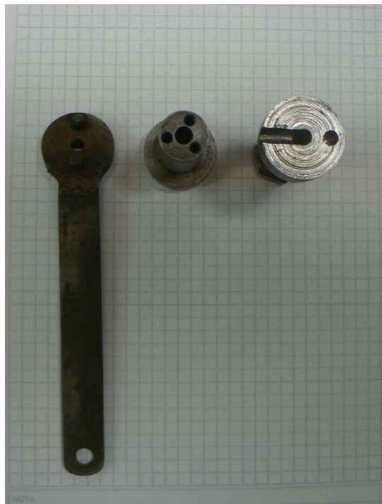
Figura 2.2. Pieza de conmutación y llave diseñada especialmente para la manipulación de esta pieza.
