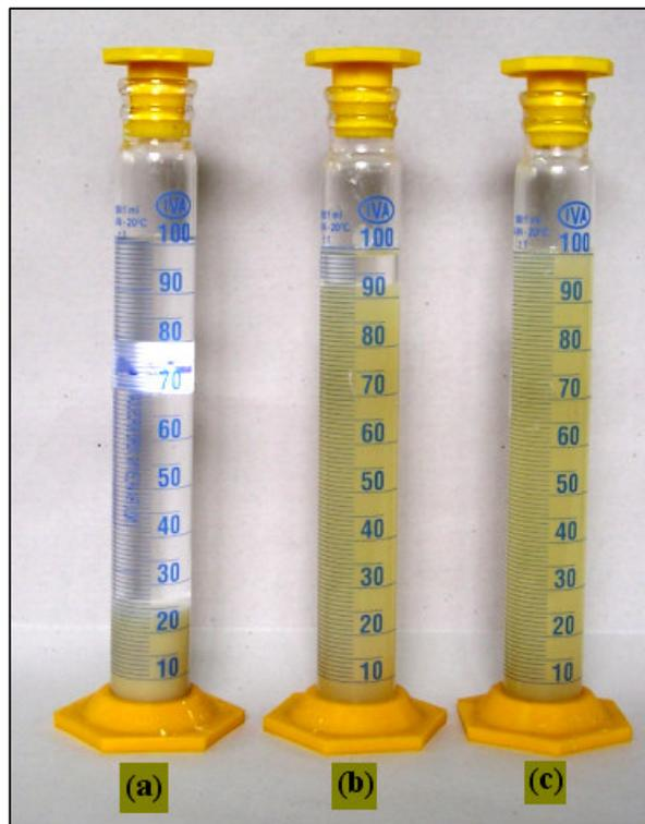
**Figura 19.** Hinchamiento libre de Cloisite 30B en: (a) diclorometano, (b) diclorometano-dimetilformamida al 50% v/v, (c) dimetilformamida.
