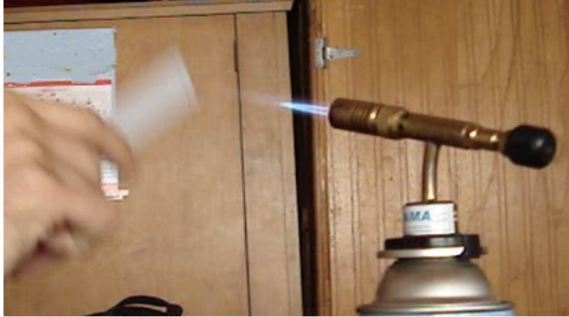
Figura 19: Fotografía del tratamiento con llama, probeta de UHMW-PE.
