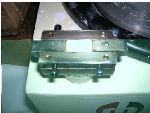
Figura 5.5: Soporte ( 60 \times 30 \times 10 \text{ mm}^3 ) construido para soportar muestras de ( 12 \times 10 \times 13 \text{ mm}^3 )
