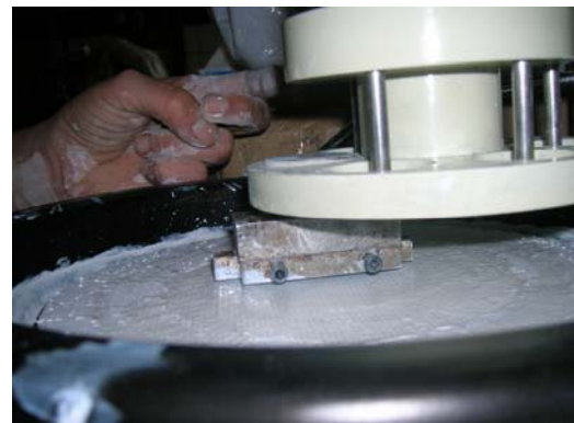
Figura 5.5: Soporte ( 60 \times 30 \times 10 \text{ mm}^3 ) construido para soportar muestras de ( 12 \times 10 \times 13 \text{ mm}^3 )
